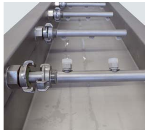
快换喷射管, 可以运行过程中进行简单维护
